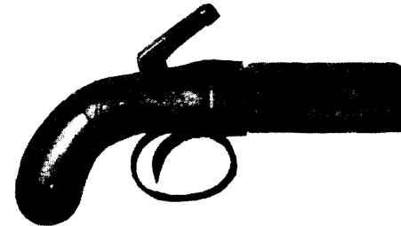
Fig. 70 b. Bündel-Revolver von Allen, 1845. Hammer über dem aus fünf glatten Läufen gebildeten Bündel. Gespannt. Perkussionszündung.
