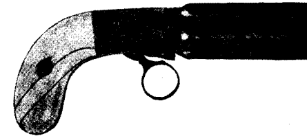
Fig. 70 a. Bündel-Revolver von Mariette, ca. 1830. Selbstspanner ohne Spann- und Ruhrast. Hammer unter dem aus vier glatten Läufen gebildeten Bündel. Perkussionszündung.
